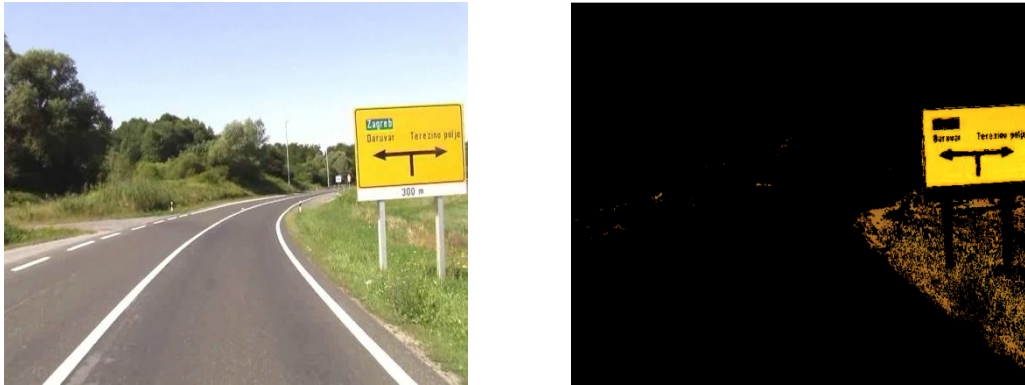
Slika 9 : Izdvajanje piksela sa slike koji odgovaraju zadanom intervalu
