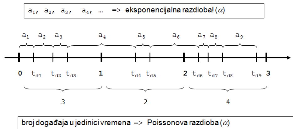
Slika 7.10. Modeliranje broja dolazaka poslova Poissonovom razdiobom
