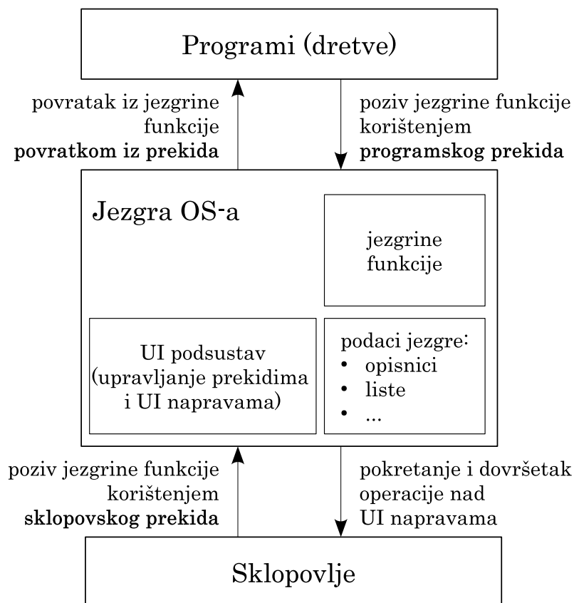
Slika 5.1. Mehanizam poziva jezgrinih funkcija
