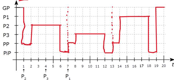
2. Prikazati stanje procesora pri obradi navedenih zahtjeva za prekid u slučaju da sustav **nema** sklop za prihvatanje prekida, ali **ima** programski ostvaren prihvatanje prema prioritetima. Prioriteti prekida su:  $\text{prio}(P_3) > \text{prio}(P_2) > \text{prio}(P_1)$ , a trajanje prihvata prekida 1 ms, obrade prekida 4 ms te povratka iz prekida 1 ms.
