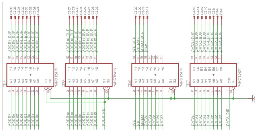
Slika 23: Međuspremnici na adresnoj i podatkovnoj sabirnici te upravljačkim signalima
