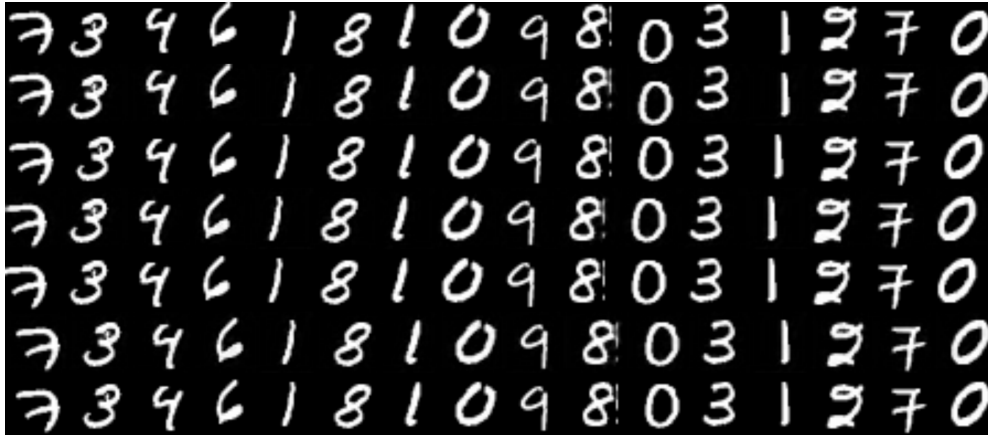
Slika 5.3: Rezultati rekonstrukcije u eksperimentu s kapsulama, po recima: (prvi) ulazna slika, (drugi) očekivani izlaz, (treći) rekonstruirani izlaz, (četvrti) ulazna slika translirana u lijevo za 3 piksela, (peti) rekonstruirana slika za ulaz u četvrtom retku, (šesti) ulazna slika translirana u desno za 3 piksela, (sedmi) rekonstruirana slika za ulaz u šestom retku
