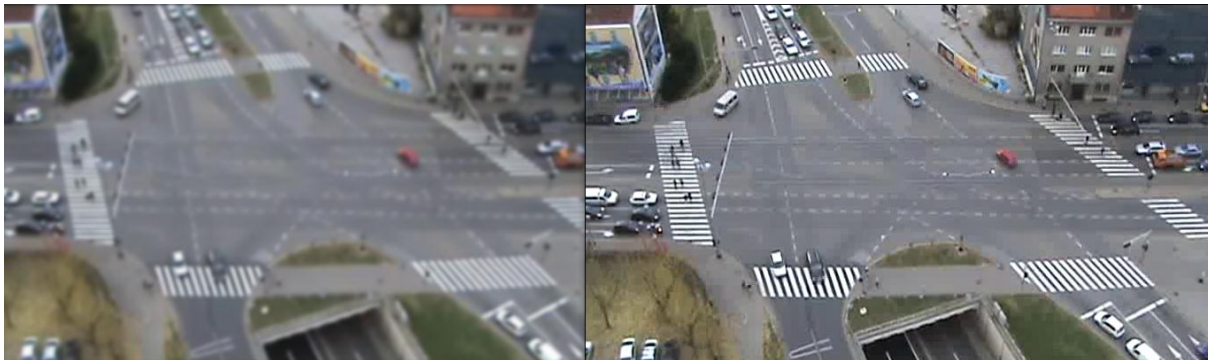
Slika 2.1 Slika s Gaussovim zaglađivanjem (lijevo) te izvorna slika (desno)
