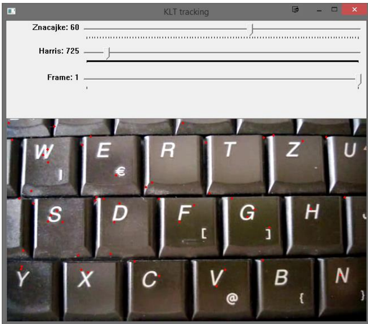
Slika 5.2 – Crvenim rombovima su označene praćene značajke. Na vrhu prozora 'KLT tracking' se mogu vidjeti postavke programa koje se mogu interaktivno mijenjati.
