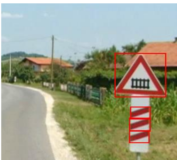
Slika 70. Lažno pozitivna detekcija na temelju boje
