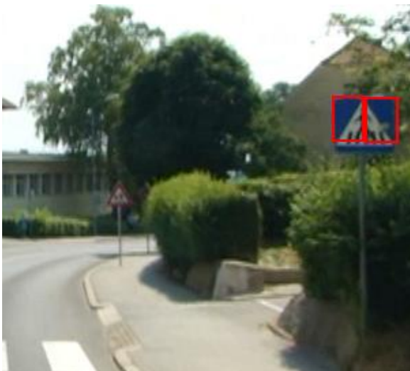
Slika 57. Lažno negativna detekcija na temelju boje
