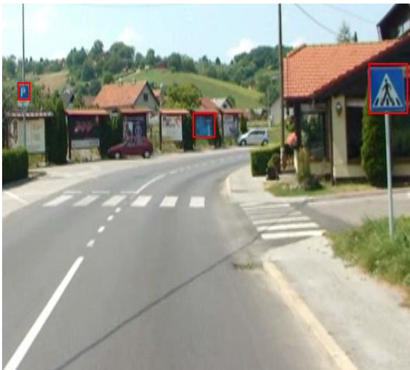
Slika 49. Lažno pozitivna detekcija na temelju boje
