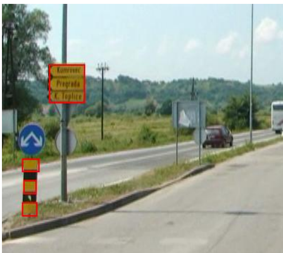
Slika 27. Lažno pozitivna detekcija na temelju boje
