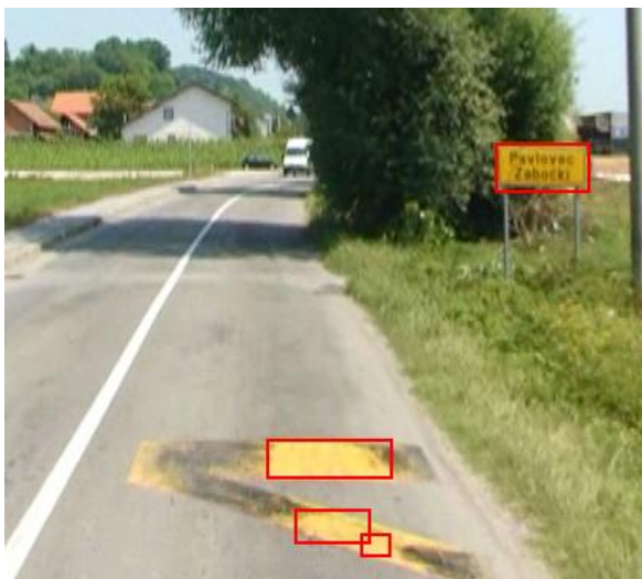
Slika 23. Lažno pozitivna detekcija na temelju boje
