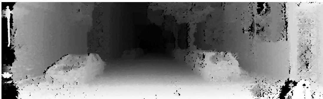
Slika 2.12: Prikaz disparitetne mape izračunate SGBM metodom
