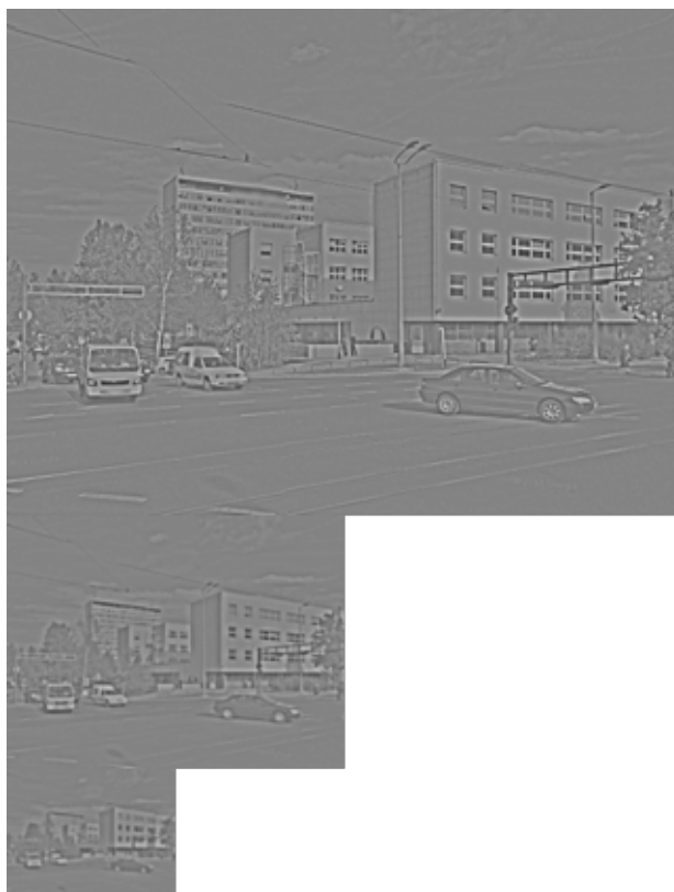
Slika 5.4: Prve tri razine Laplaceove piramide. Slika je dobivena skaliranjem vrijednosti iz raspona [-1, 1] na raspon [0, 255] .
