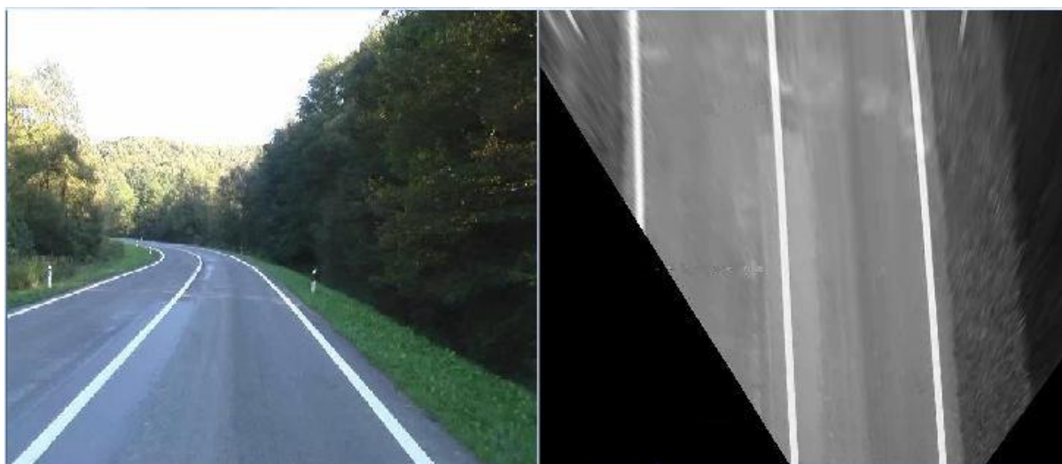
Slika 1. Izvorna slika iz perspektive vozača (lijevo) i odgovarajuća inverzna perspektivna slika (desno)
