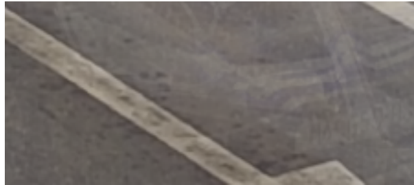
Slika 6.: Početna pozadina virtualne petlje dobivena usrednjavanjem 20000 slika na video snimci iz prvog ispitnog skupa
