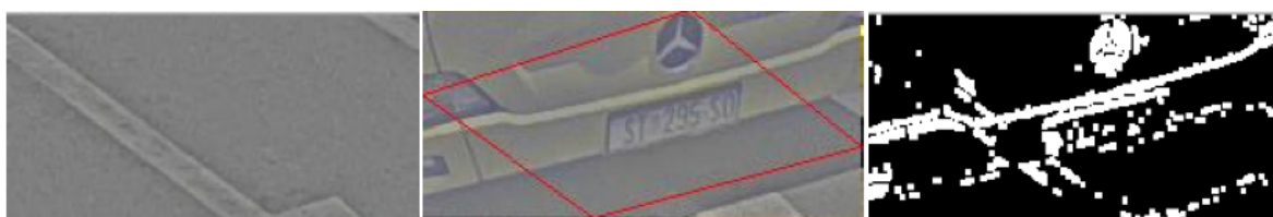
Slika 5.: Teksturna slika pozadine, trenutne ulazne slike i detektirana razlika u teksturi
