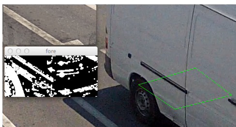
Slika 9. (lijevo): lažno negativna detekciju zbog velike sličnosti vozila i pozadine, prag zauzetosti petlje je >40\%
