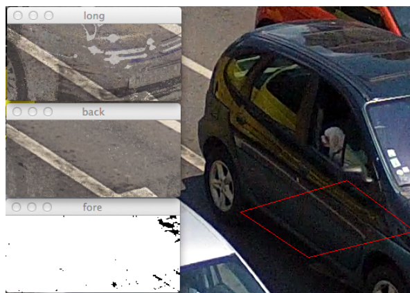
Slika 9. Uspješna detekcija, detekcijski model s dvostupanjskim MOG postupkom, back prozorčić prikazuje trenutno stanje prvog stupnja, long prikazuje drugi stupanj modela pozadine, a fore detektirane piksele prednjeg plana
