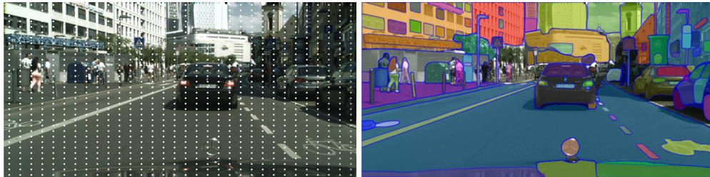
Slika 3.8: Primjer generiranja maski koristeći model SAM. Na ulaznoj slici (lijevo) zadamo rešetku ključnih točaka, a SAM na izlazu daje sve pronađene maske (desno) pokrivene nekom od zadanih točaka. Prikazana ulazna slika preuzeta je iz skupa podataka Cityscapes [11].
