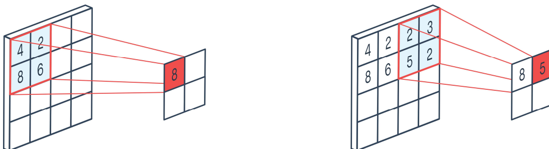
Slika 3.2: Sažimanje maksimumom (engl. max pooling) u oknu veličine 2 \times 2 s korakom 2.
