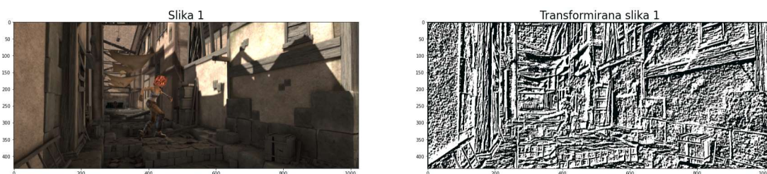
Slika 5.6: Primjer provođenja ternarne census transformacije. Slika prikazuje jedan kanal dobivene transformacije, dok broj kanala ukupne transformacije sadrži broj kanala ovisan o broju piksela u susjedstvu.
