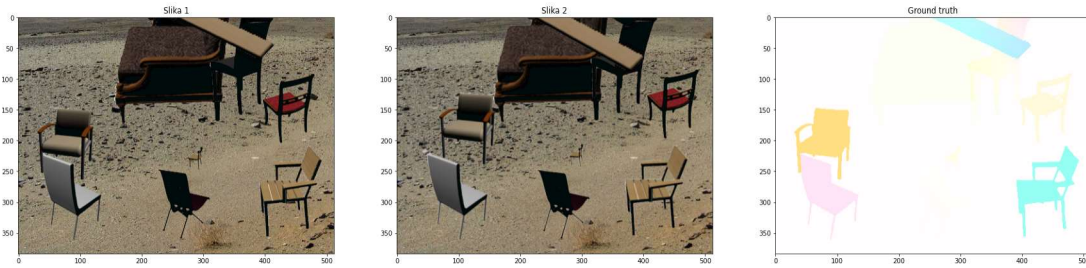
Slika 6.2: Primjer para slika iz skupa Flying Chairs te odgovarajući točni optički tok.
