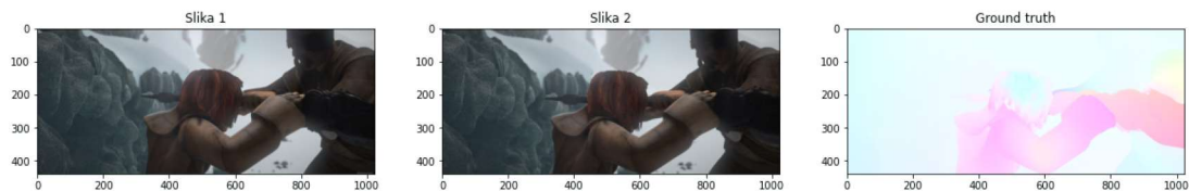
Slika 6.8: Primjer para slika iz skupa Sintel final te odgovarajući točni optički tok.
