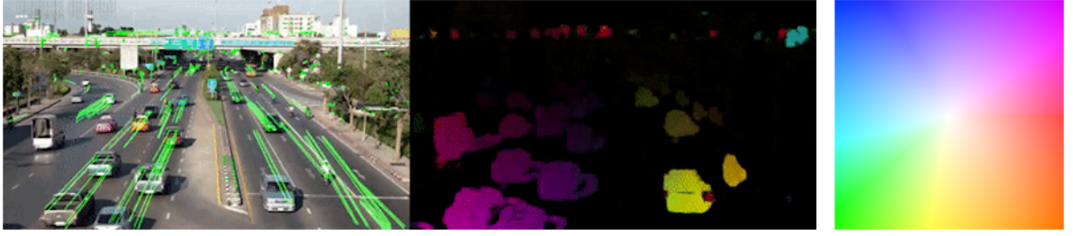
Slika 2.8: Prikaz optičkog toka. Lijeva slika pokazuje stvarnu sliku nad kojom se računa optički tok. Zelene linije su tragovi točaka koje one ostavljaju dok se gibaju. Na srednjoj slici prikazan je procjenjeni optički tok. Pošto je kamera fiksna, vidljivo je da se ništa ne miče osim auta. Boje na prikazu optičkog toka označavaju kut pod kojim se objekt giba, a odnos kuta i boje pokazuje nam shema sa desne strane. Na shemi vidimo da snažnije boje prikazuju brže gibanje, a bljeđe boje sporije. Prema toj shemi, auti u lijevoj traci voze se prema gore, a u desnoj prema dolje, dok je najniži auto desno spreman za skretanje.
