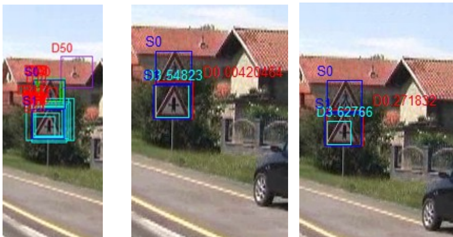
Slika 4.1: Prikaz grupe detekcija i reprezentativnih odziva odabranih primjenom binarnih klasifikatora s RBF i linearnom jezgrom i reprezentativnih odziva nastalih metodom grupiranja [10]
