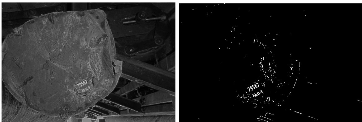
Slika 2.10: Lijeva slika prikazuje izlaz maksimalnog odziva, desna prikazuje rezultat nakon filtriranja 1.5% najsvjetlijih piksela iz histograma slike
