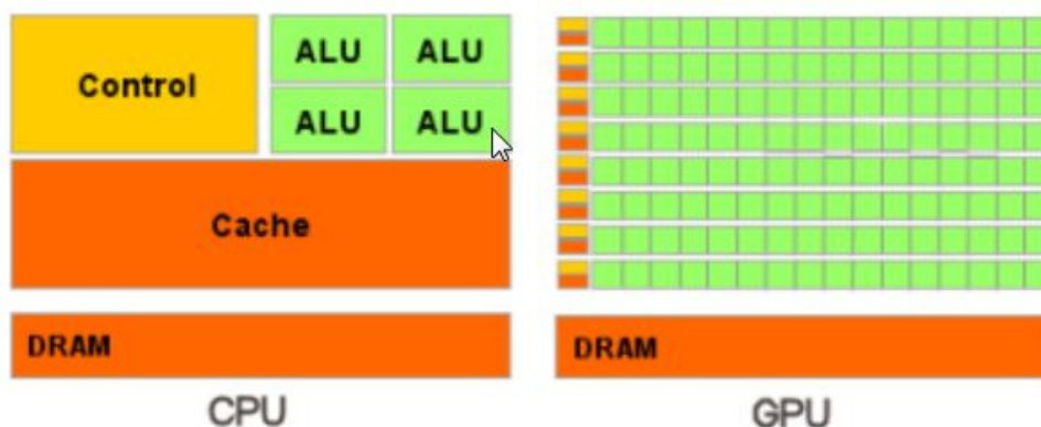
Slika 3. CPU i GPU posjeduju temeljne razlike u dizajnu
