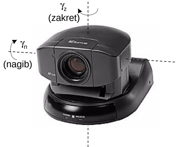
Slika 3.2: Upravljiva kamera s dva stupnja slobode.
