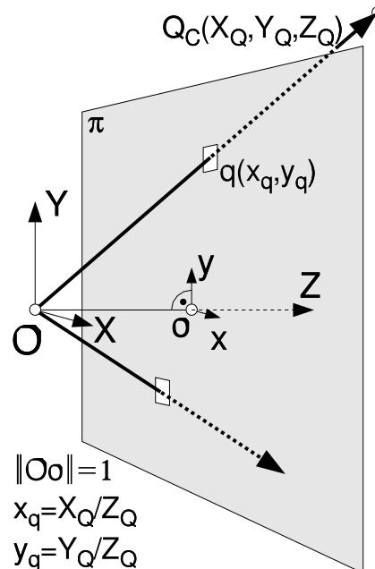
$$\lambda \cdot \begin{bmatrix} x_{\hat{q}} \\ y_{\hat{q}} \\ 1 \end{bmatrix} = \begin{bmatrix} 1 & 0 & 0 & 0 \\ 0 & 1 & 0 & 0 \\ 0 & 0 & 1 & 0 \end{bmatrix} \cdot \begin{bmatrix} X_Q \\ Y_Q \\ Z_Q \\ 1 \end{bmatrix} \quad (5)$$
